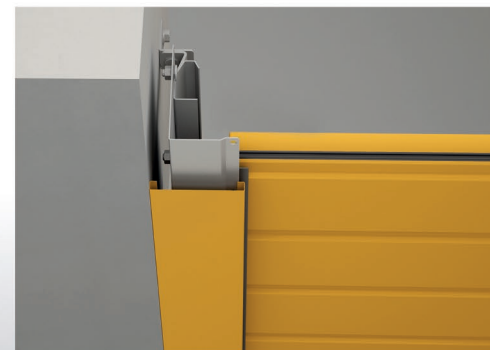
Montaż w otworze - maskownica w otworze
