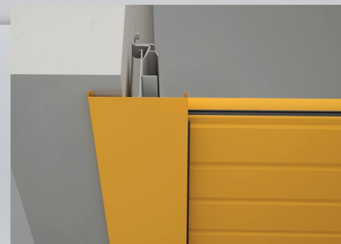
Montaż w otworze - maskownica przed otworem
